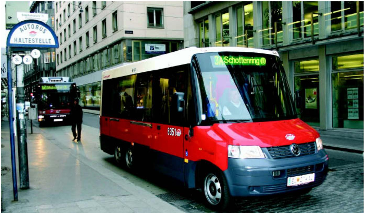
Der neue Kleinbus ist wendiger, kürzer und schmaler als die bisher verwendeten Busse und eignet sich damit hervorragend für die schmalen Straßen und Gassen der Wiener Innenstadt. Angetrieben wird der klimatisierte Bus mit Flüssiggas. Er verfügt über einen VW-Motor, der 235 PS leistet. Geschaltet wird über ein 6-Gang Tiptronic-Automatikgetriebe.
